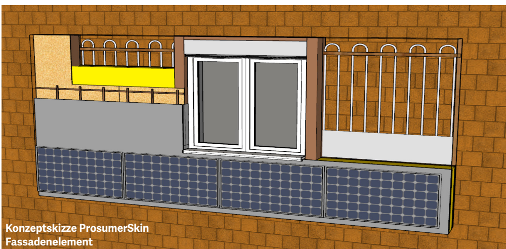
Modernisierter Zustand nach der Installation der Fassadenelemente auf die bestehende Wand mit aussenliegender Wandheizung (P&D ProsumerSkin, Bern). Fassade als auch Balkonbrüstung sind mit PV-Modulen zur Eigenstromerzeugung ausgerüstet.
