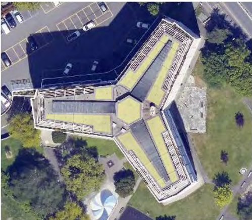
Installation de panneaux solaires thermiques sur les parties utiles en toiture (jaune): 335 m2
